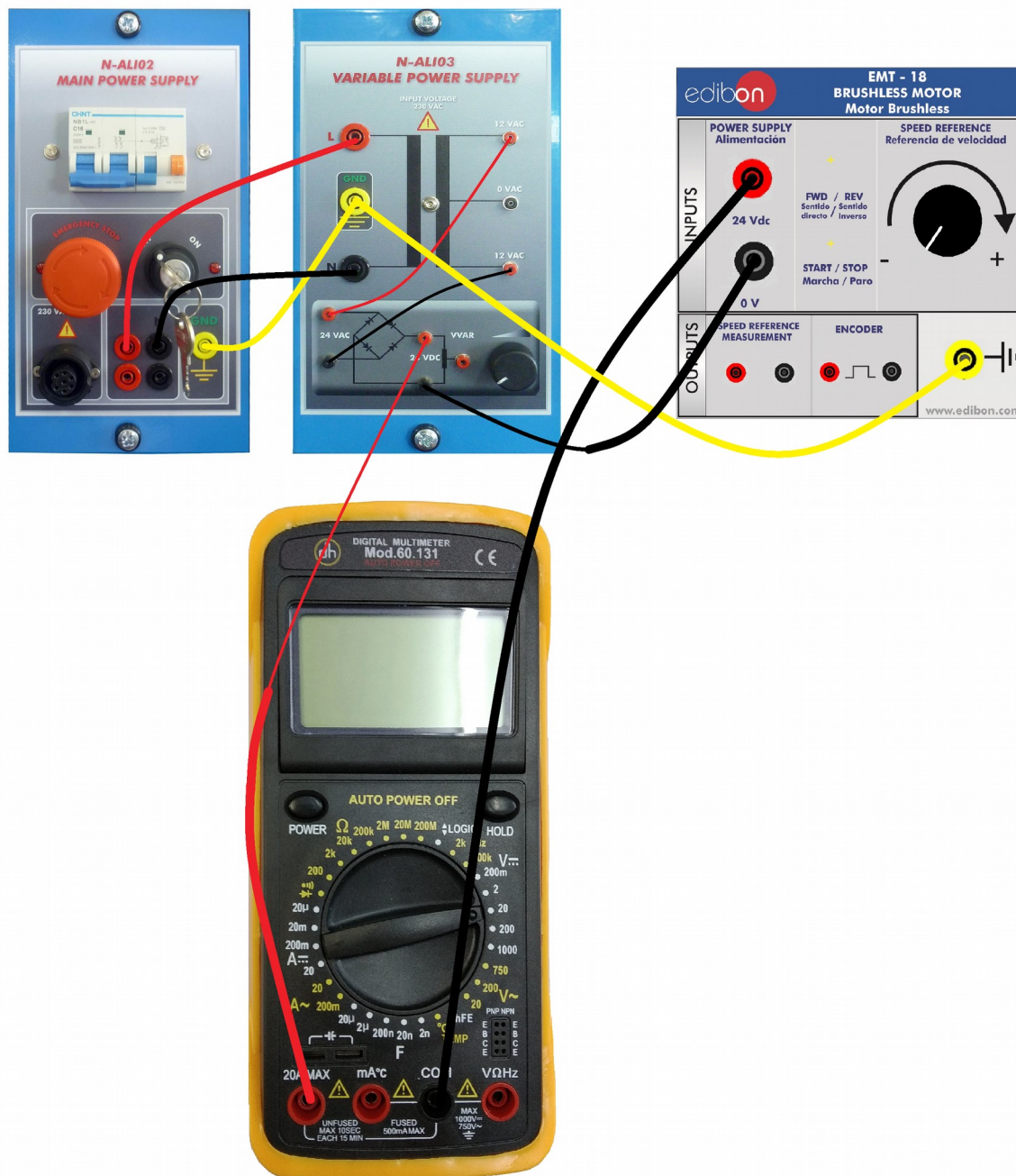
Attēls 26. Moduļu savienojumi un ampermetra pieslēgums motora patērētās strāvas mērījumiem.
