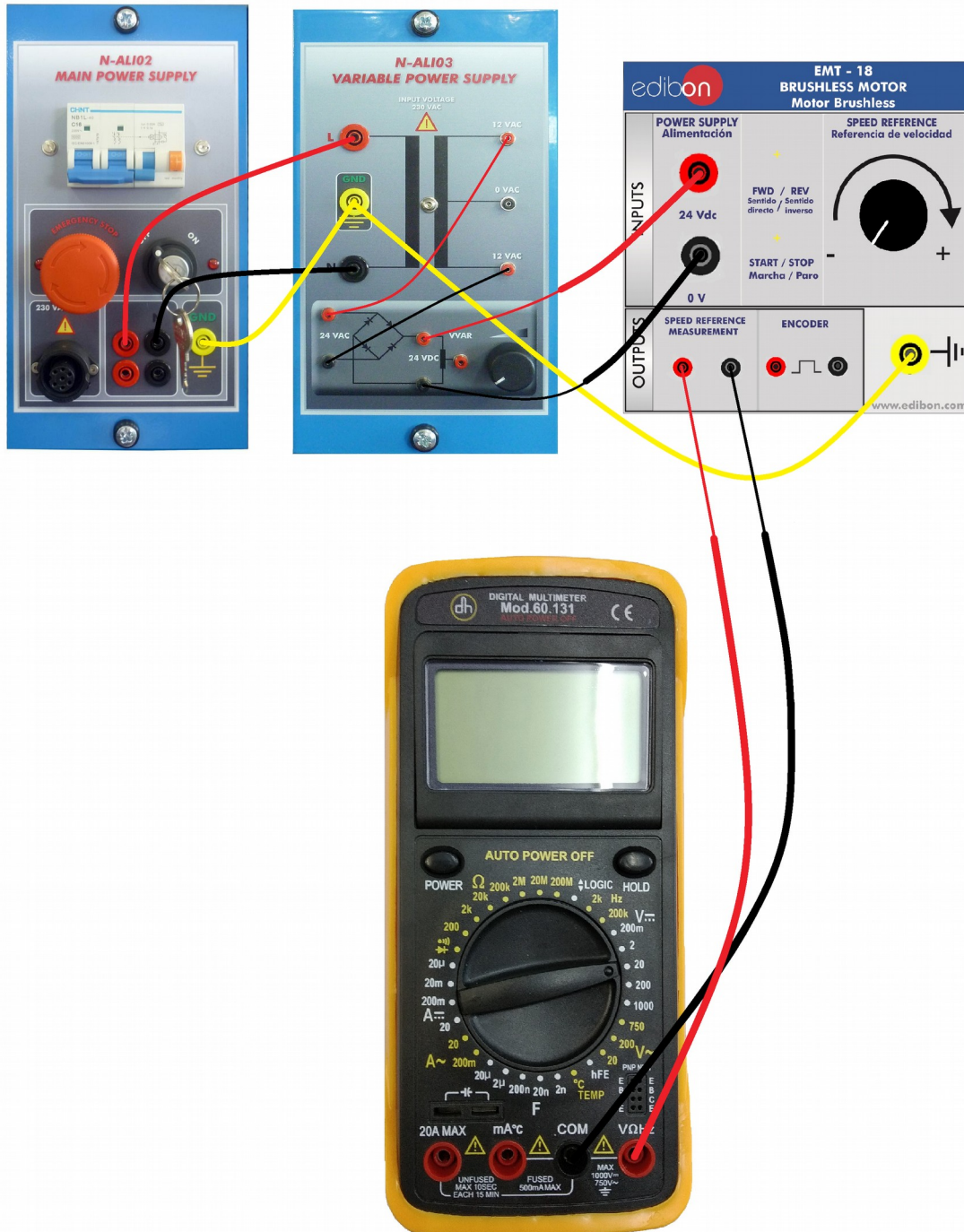
Attēls 27. Moduļu savienojumi un voltmetra pieslēgums motora rotācijas ātruma mērījumiem.
